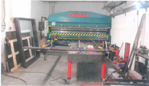
Vue sur la table à brider et la Combi qui fait presse plieuse et cisaille.
