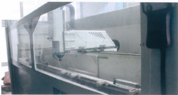
Vue sur la table à brider et la Combi qui fait presse plieuse et cisaille.
